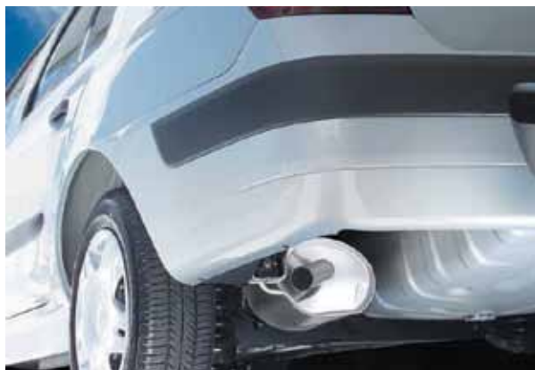
Aço 439 utilizado em um escapamento
